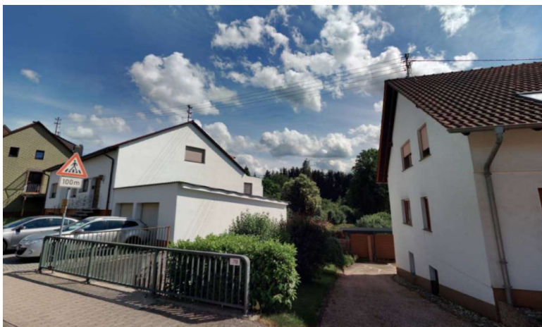
Beispiel Freileitungsnetz mit Dachständernetzanschlüssen
